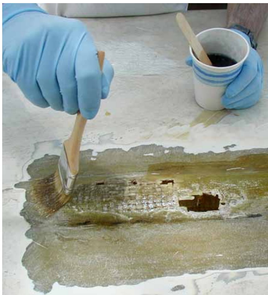
O grande segredo é a preparação da superfície do laminado
