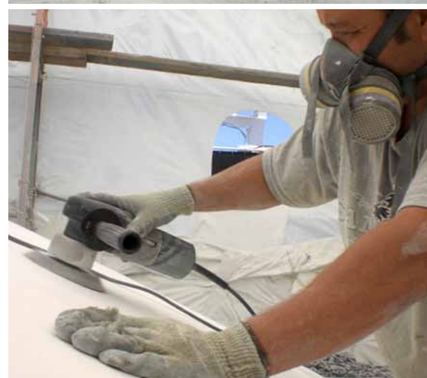
Laminados de resina epoxy aderem muito bem sobre resina poliéster
